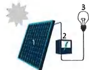
1. Zonnepaneel | 2. Omvormer | 3. Elektrische toestellen
